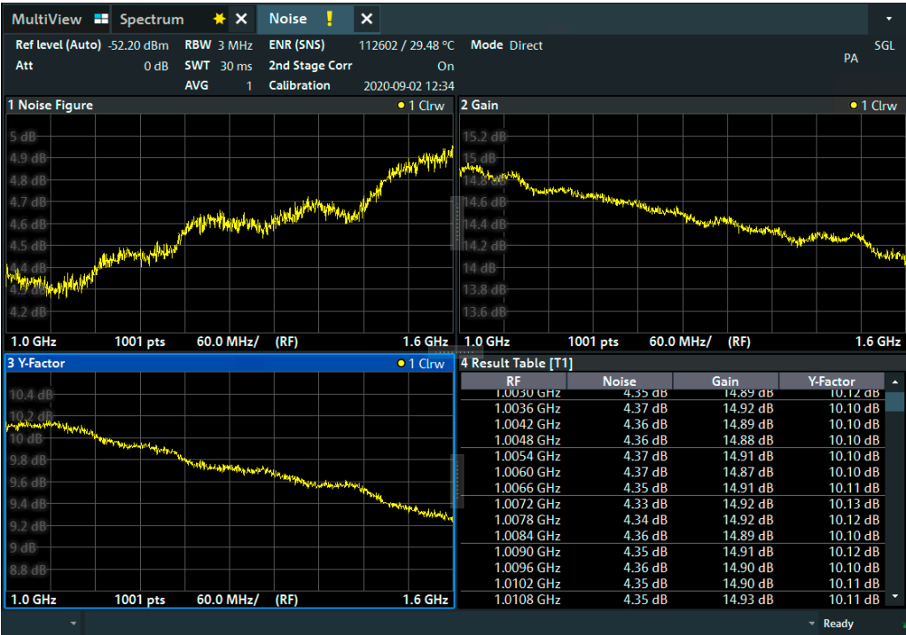
Одновременное отображение графиков коэффициента шума, усиления и Y-фактора в зависимости от частоты и таблица результатов в числовом формате
