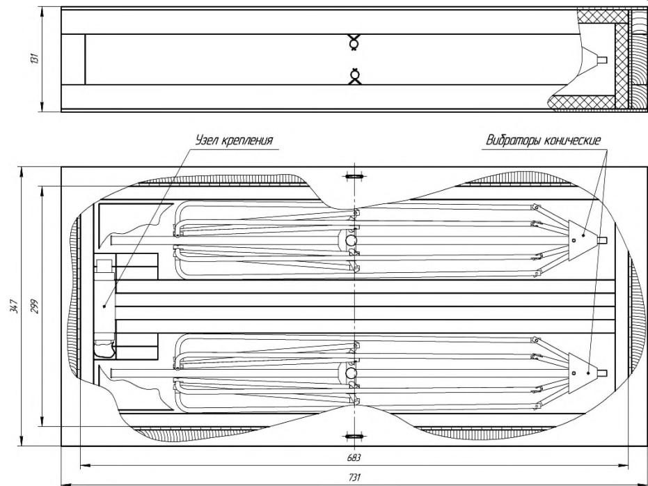
Рисунок 3 – Общий вид антенны П6-121 в укладочном ящике
