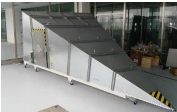
Ячейка GTEM - это, коническая коаксиальная линия (смещенная перегородка), которая заканчивается гибридной комбинацией дискретных резисторов и РЧ-поглотителем для достижения широкополосного согласования 50 Ом. Применяется для измерения радиационных излучений и испытаний на радиочастотную помехоустойчивость.
