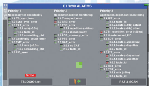
Проверка содержимого и ошибок транспортного потока с записью в лог-файл.
