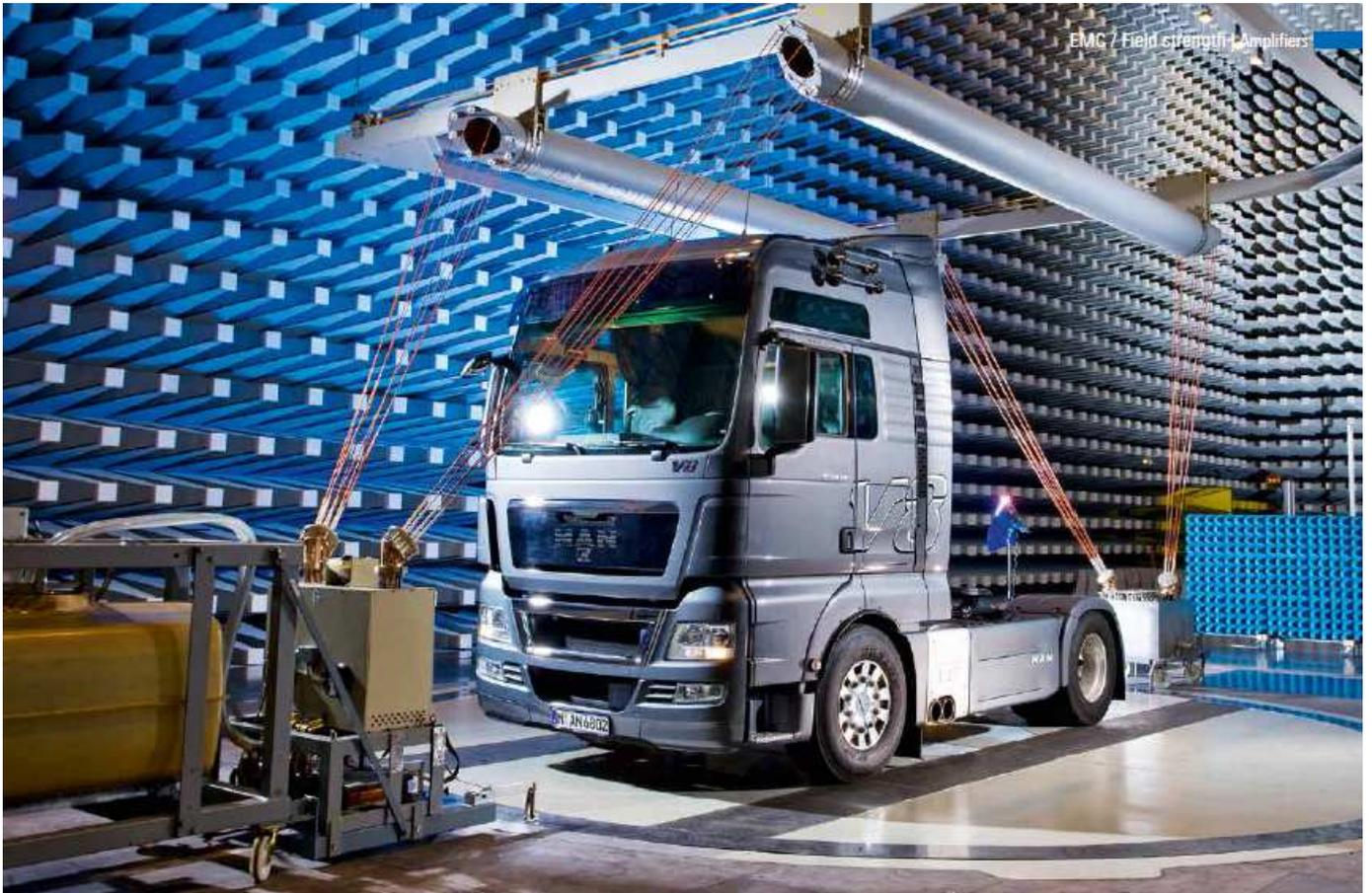
Компания Rohde & Schwarz разрабатывает и внедряет в интересах заказчика готовые системы для проведения сертификационных испытаний на помехоустойчивость/восприимчивость (ЭМВ) к кондуктивным помехам и излучению в соответствии с коммерческими, беспроводными, автомобильными и военными стандартами.
