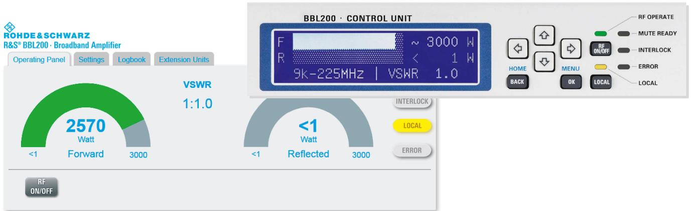
Управлять усилителем можно с помощью кнопок на передней панели прибора. Информация о состоянии и настройках отображается на небольшом монохромном ЖК дисплее.
