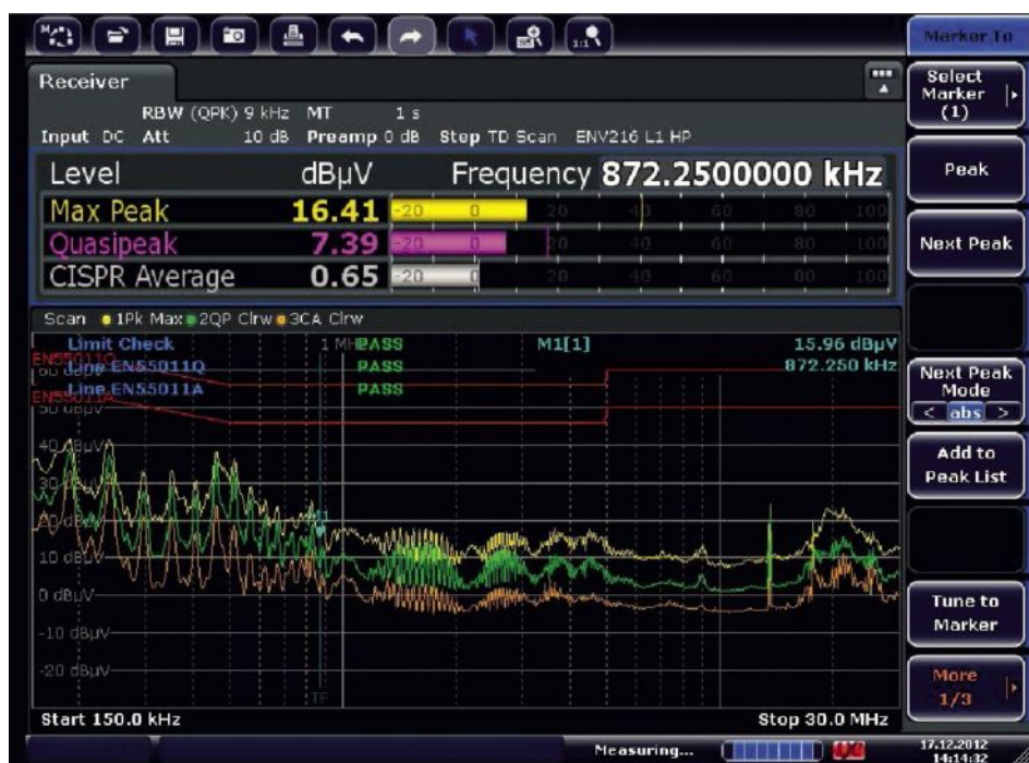
Рисунок 6 – Измерение кондуктивных помех в один прием в диапазоне CISPR B.
