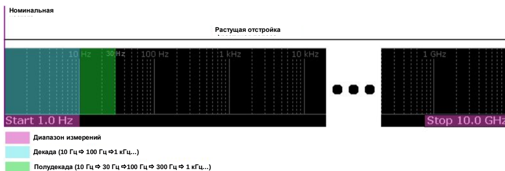
Рис. 4-3 – Диапазон измерений и полудекады
