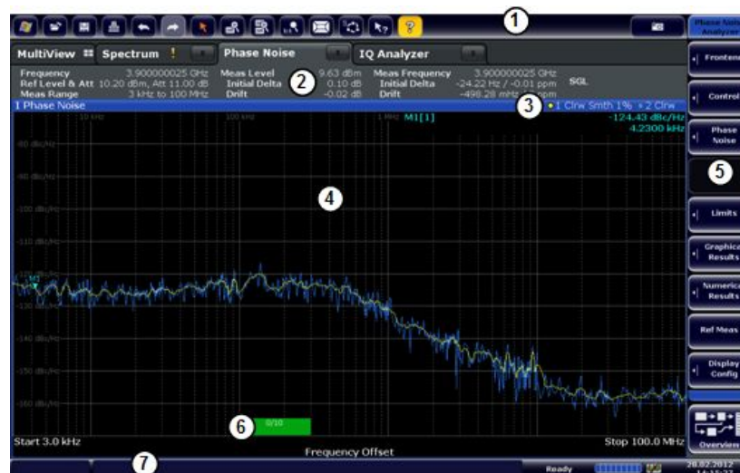
Рис. 2-1 – Вид экрана приложения для измерения параметров фазового шума
